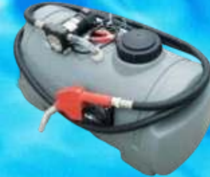
Дизельный насос DC с резервуаром Модель: DD100E Резервуар 100л / 27 галлонов Самовсасывающий дизельный насос 12В 40 л/мин / 10,6 галлонов/мин Высококачественный раздаточный пистолет с автоматическим выключением 4-метровый раздаточный шланг 3/4 с вращающимися и обжимными фитингами 4-метровый электрический кабель Размер: 900x500x480мм Вес: 14 кг 120 комплектов в одном 20 футовом контейнере
