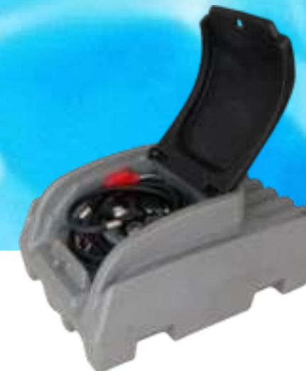
Дизельный насос DC с резервуаром Модель: DD200 Резервуар 200л / 54 галлонов Дизельный насос 12В 40 л/мин / 10,6 галлонов/мин Крышка с замком Высококачественный раздаточный пистолет с автоматическим выключением 4-метровый раздаточный шланг 3/4 с вращающимися и обжимными фитингами 4-метровый электрический кабель Размер: 1050x747x570мм Вес: 35,8 кг 60 комплектов в одном 20 футовом контейнере
